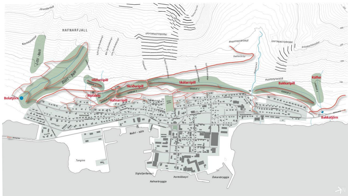
Mynd 18. Snjóflóðavarnargarðar ofan Siglufjarðar.
